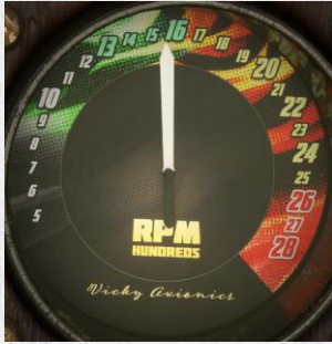
Indicateurs de tours/minute pour l'hélice.
