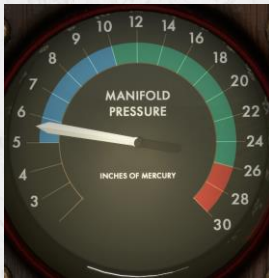
Indicateur de pression d'admission (manette de gaz).
