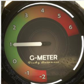
Accéléromètre. Si vous entrez dans l'orange sombre, les LEDs s'allumeront et une alarme retentira.
