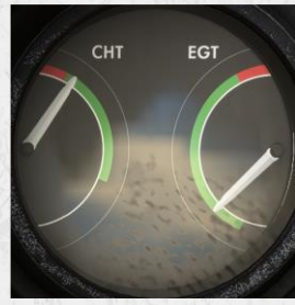
Double jauge : Température de tête de cylindre et température de gaz d'échappement.
