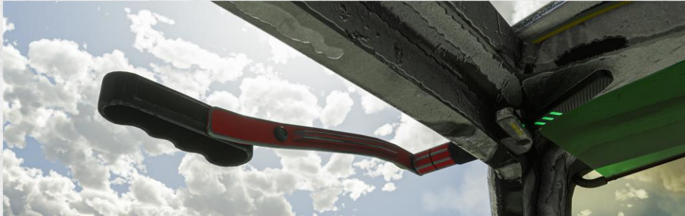
Sur cette photo, vous avez les volets rétractés (levier rouge vers le haut) et le rétracteur automatique de volets est déjà armé.
